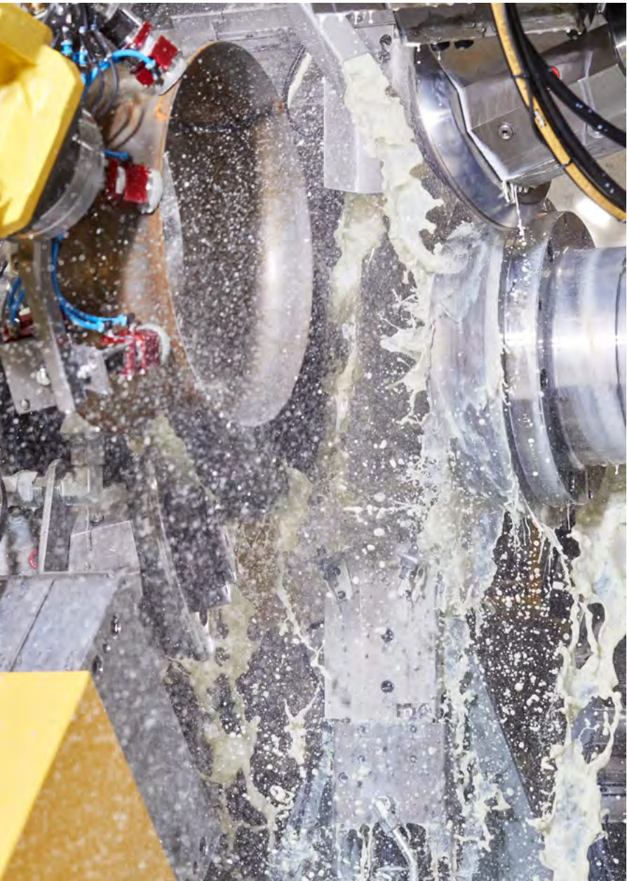
An einer HABS werden die Ronden im zweiten Schritt beschnitten und entgratet.
