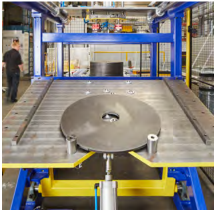
Der Ronden-Abstapler vereinzelt Stapel von bis zu 3x40 Ronden und führt sie dem Roboter zu.
