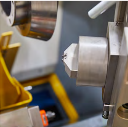
An einer HABS werden die Ronden im zweiten Schritt beschnitten und entgratet.
