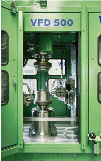
Arbeitsraum einer VFD
