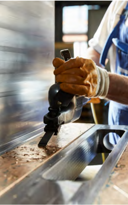
Handgefertigte Bronze-Führungsleisten – ein Qualitätsmerkmal von WF
