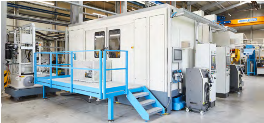
Rechts: HSTA 550-4 zum Auswalzen der Felgenreife. Ein Roboter im Zentrum reicht die Werkstücke von einer Maschine zur nächsten.
